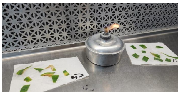
Figura 2. Secado en condiciones asépticas de muestras foliares de maíz provenientes de Pergamino y San Jorge, luego de la desinfección superficial y los enjuagues con agua destilada estéril.
